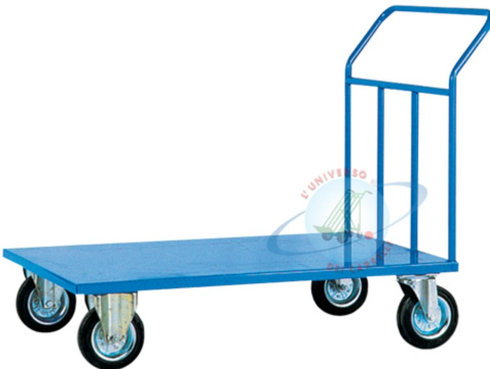
**Pianale in lamiera con chassy portante in tubolare. Piano di appoggio in lamiera 20/10 con telaio portante in tubolari. Le contropiastre saldate alla struttura permettono una rapida sostituzione del supporto ruota.**
